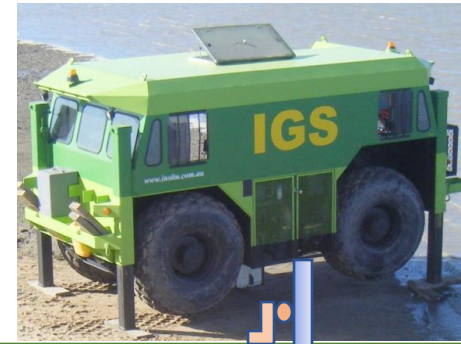
CPT Rig (20 tonnes)
